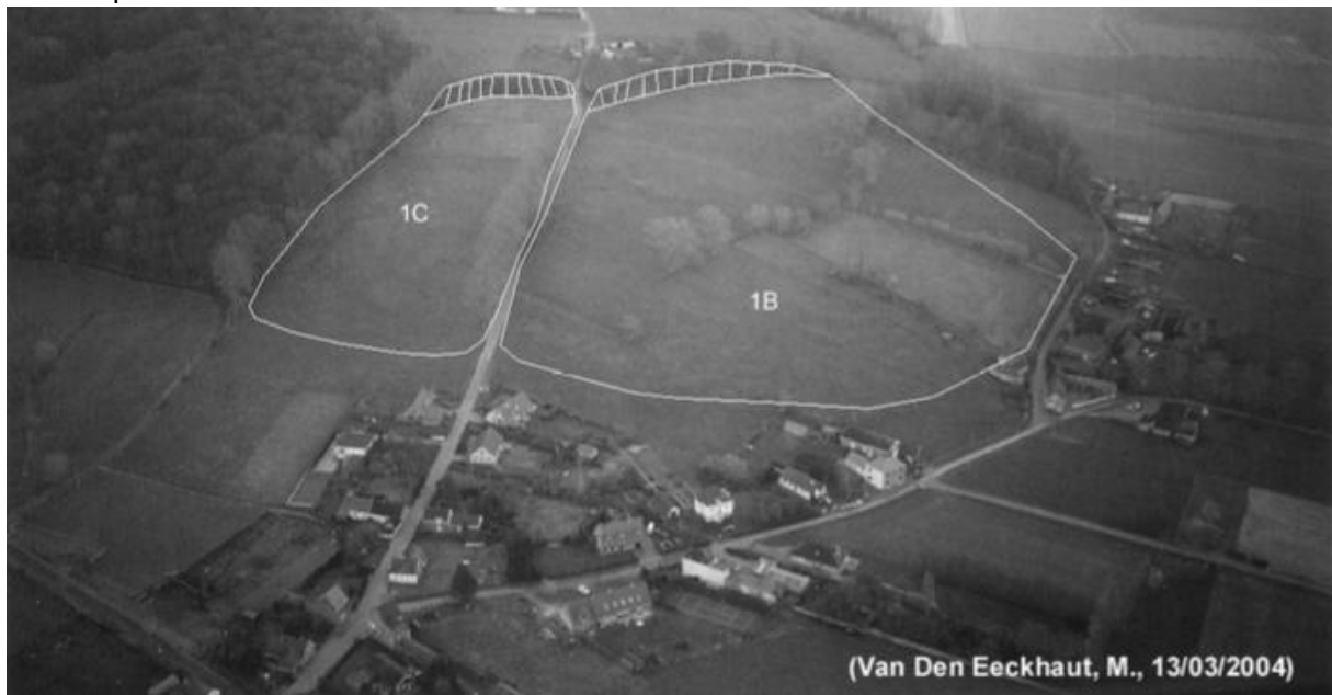
Foto 1: Zicht op grondverschuiving 1b en 1c met aanduiding van de met bomen beplante hoofdsteilrand (verticale lijnen). Bron: zie figuur 7.
